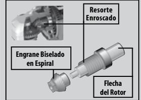
La flecha de dirección del rotor tiene un resorte conectado al engrane
